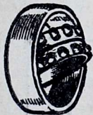
108-сүрөт. Эки катарлуу шариктүү подшипник.
